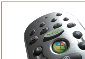
Il telecomando del software Speaky Domotica, con microfono integrato, consente il controllo vocale dei dispositivi d'automazione
